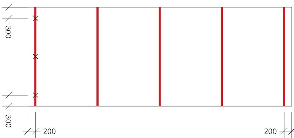
2. Dachziegel an den ausgemessenen Punkten entfernen.
